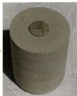
水和反応による膨張開始
