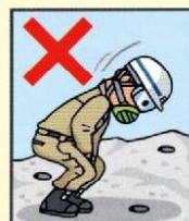
亀裂発生まで 直接孔を覗かない
