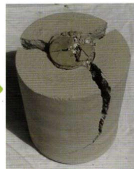
体積膨張が拘束されているため、孔内に強力な結晶圧が発生
